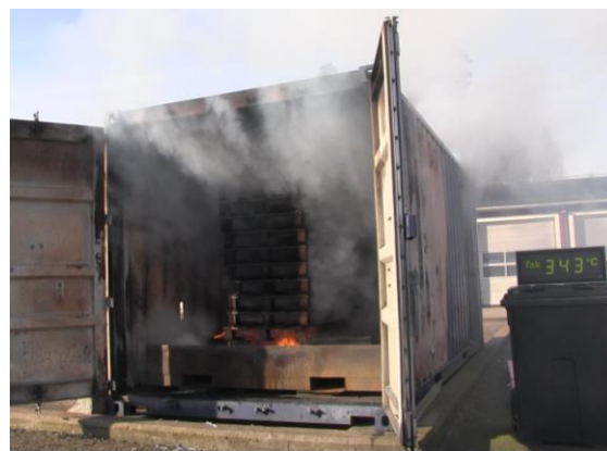
Efter släckförsöken fanns det kvar brandhårdar för att öka risken för återantändning
