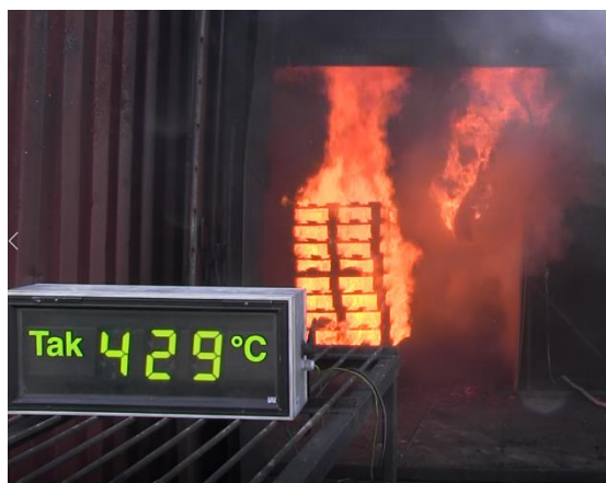
Fasaden på väg att rasa, men fortfarande inte antändning på höjden 120 cm och nedåt.
