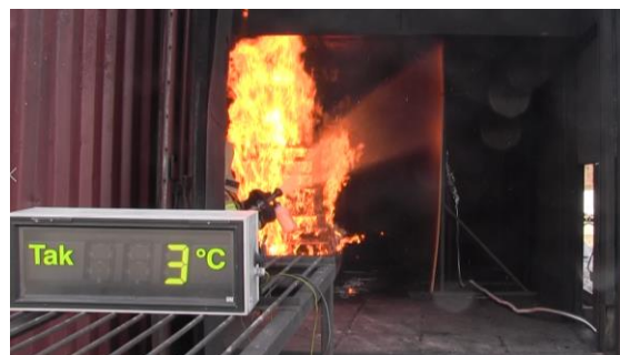
Applicering av släckmedel på fasad, 10 sekunder efter antändning
